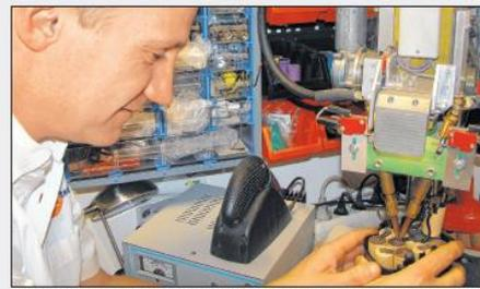
Nicht gleich neu kaufen: Mit einem Punktschweißgerät können alle Werkzeuggehäuse oft repariert werden. Foto: Axel Böhm
