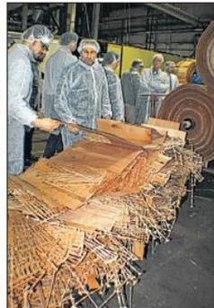
Der Produktionsabfall wird später zu großen Brennholz-Stücken gepresst.
